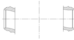
BW end acc. to EN 12627 & ASME B16.25
